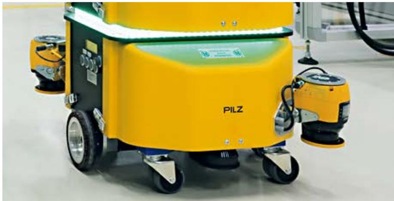
In diesem Beispiel bewegt sich das FTS in einem Gang an einer Seite einer Produktionshalle, um das für eine Maschine benötigte Material bereitzustellen. Der Gang ist breit genug, um als normale „Betriebszone“ zu gelten, wenn das FTS mit voller Betriebsgeschwindigkeit arbeitet, da Freiräume von 500 mm oder mehr zu jeder Seite erreicht werden können.
