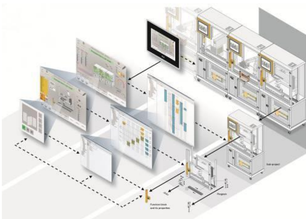
Illustration 4 : Les installations peuvent être découpées en unités dont le fonctionnement est transparent et indépendant.
