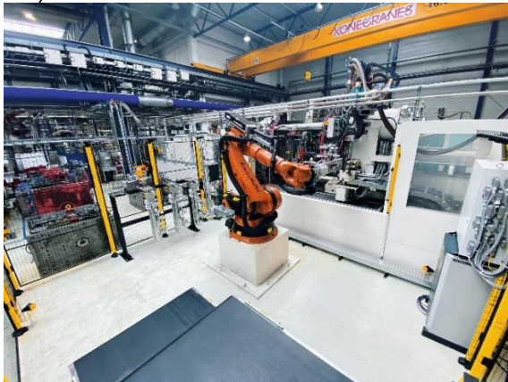
Bildunterschrift: Turvallinen solu Pilz-tutkaratkaisulla: Robotti Weiplasin ruiskuvalukoneen poistoalueella, etualalla kuljetinhihna.
