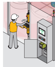
Connexion – saisie dans la liste sécurisée du système de commande Pilz.
