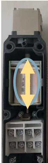
Abbildung 9 Innenansicht elektromechanische Zuhaltung PSEN me5
