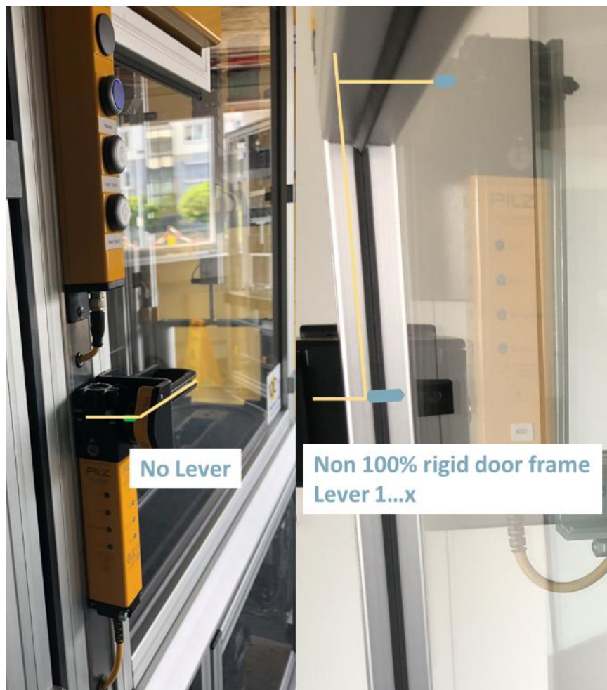
Abbildung 8 Hebelwirkung auf einer Zuhaltung an Türen
